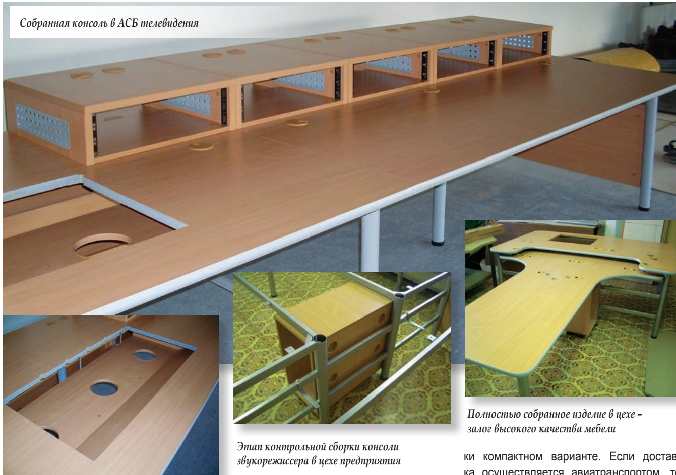
Сложный контур проема для пульта точно соответствует рекомендациям производителя оборудования
